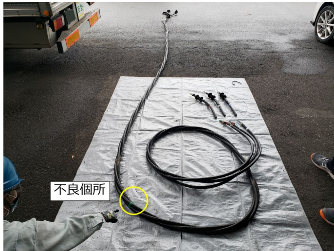
ケーブル装柱状態を模擬する。絶縁破壊の位置
